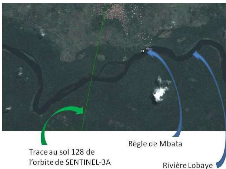
Calage de données altimétriques avec mesures in-situ sur la règle de Mbata
